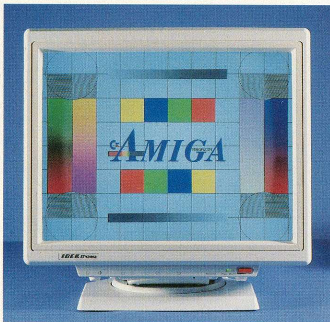
15-kHz-Monitor: Wie für den Amiga und seine Auflösungen entwickelt. Alles kann dargestellt werden.
