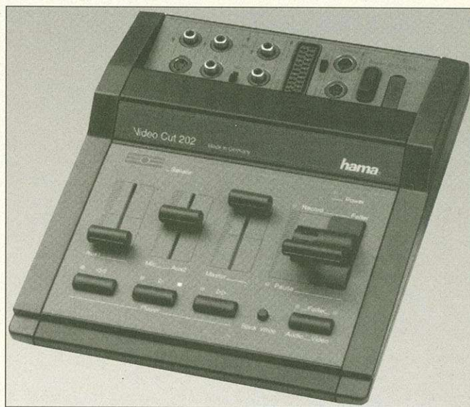
Video Cut 202: Das Videoschnittsystem eignet sich für alle Systeme und konvertiert von S-VHS nach Normalvideo
