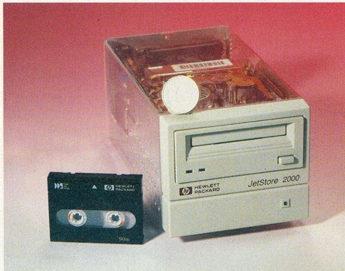
HP-DAT: Die JetStore-2000/5000-Modelle gibt es in interner und externer Version. Die Kapazität reicht bis 8 GByte.
